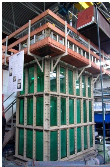
Versuchsanlage: 17 m 3 Reinwassertank (Bild:IWAR)
