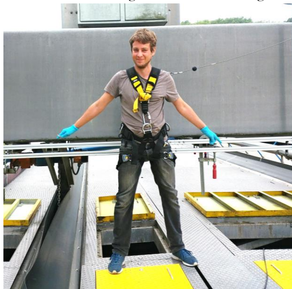
Frederik Kip auf dem Sandfang, links die ADV-Sonde, rechts die magnetisch-induktive Sonde, immer griffbereit der Imbusschlüssel zum Lockern der Verbindungen der Alustangen.
