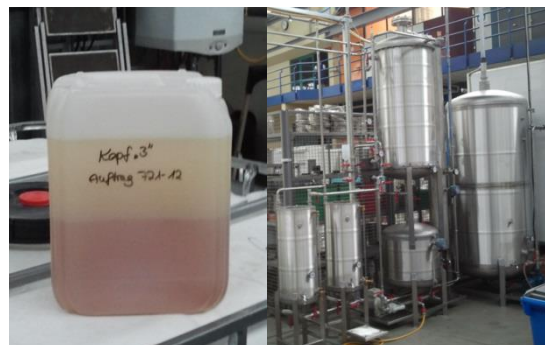
Abb. Perkolat im Sickerwasserschacht einer Rottebox
